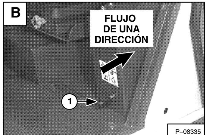
Si su excavadora está equipada con una perilla de control de flujo (ítem 1) **[C]**, tire de ésta (ítem 1) **[C]** hacia afuera. Esto permitirá que llegue únicamente flujo hidráulico al acoplador hembra.
