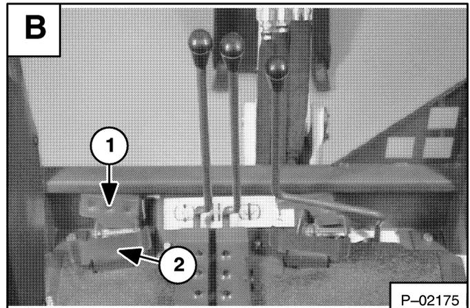
El acoplador hembra (ítem 1) [C] está bajo presión, el acoplador macho (ítem 2) [C] es de retorno cuando el pedal se empuja hacia la derecha.
