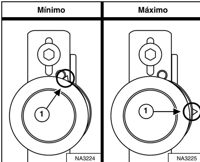
El señalador (ítem 1) [Figura 261] en la polea tensora accionada con resortes deben mantenerse entre las dos posiciones que se muestran para dar una tensión adecuada a la correa.
