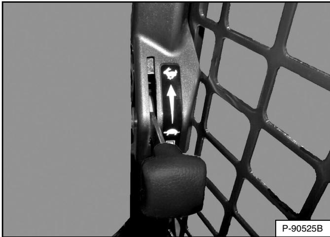
Coloque el control del motor en la posición de velocidad en ralentí baja (vacío) [Figura 130].
