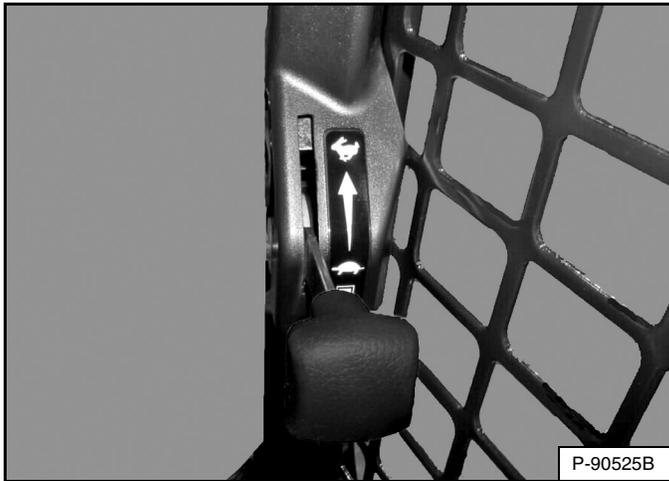
Coloque el control del motor en la posición de velocidad en ralentí baja (vacío) [Figura 125].
