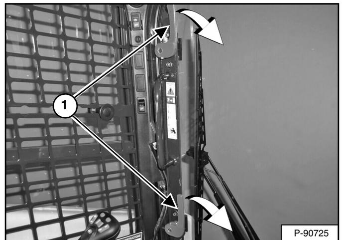
Voltee ambos cerrojos (ítem 1) [Figura 51] hacia abajo hasta que se liberen del marco de la puerta.
