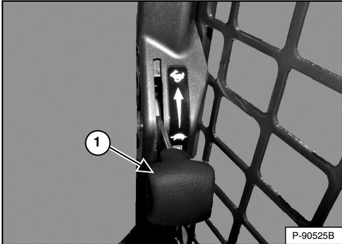
El control de velocidad del motor (ítem 1) [Figura 40] está junto al marco de la puerta, debajo del panel a mano derecha.
