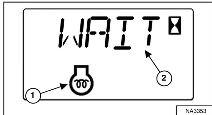
La máquina activa las bujías precalentadoras automáticamente con base en la temperatura. El ícono de precalentamiento del motor (ítem 1) y el tiempo restante del ciclo o [WAIT] (ítem 2) [Figura 127] aparece en la pantalla de datos.
