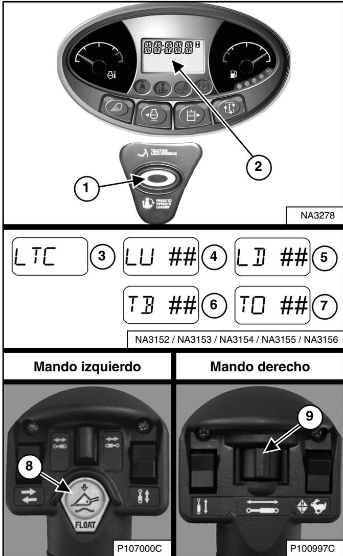
LTC – Compensación de elevación e inclinación
