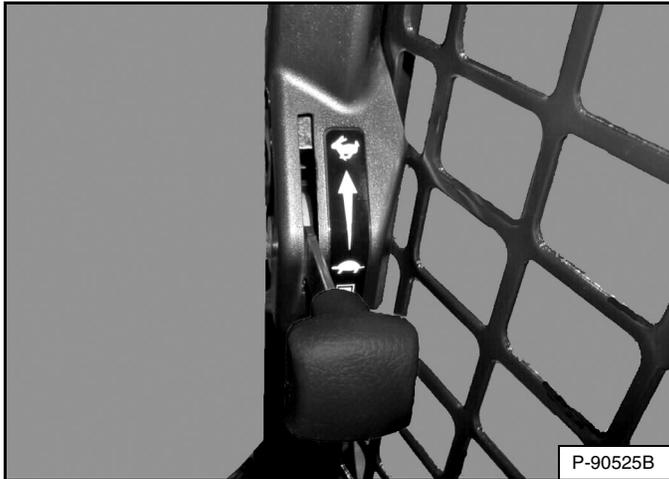
Coloque el control del motor en la posición de velocidad en ralentí baja (vacío) [Figura 120].
