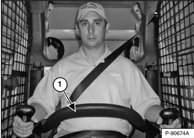
El sistema de restricción del asiento tiene una barra del asiento que hace pivote con descansabrazos (ítem 1) [Figura 37].
