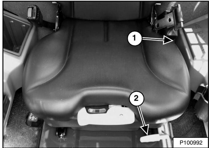
Tire de la palanca (ítem 1) [Figura 111] hacia arriba para ajustar el ángulo del espaldar del asiento.
