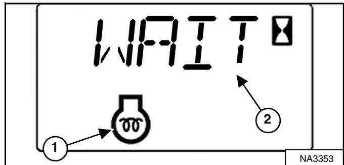
La máquina activa las bujías precalentadoras automáticamente con base en la temperatura. El ícono de precalentamiento del motor (ítem 1) y el tiempo restante del ciclo o [WAIT] (ítem 2) [Figura 132] aparece en la pantalla de datos.
