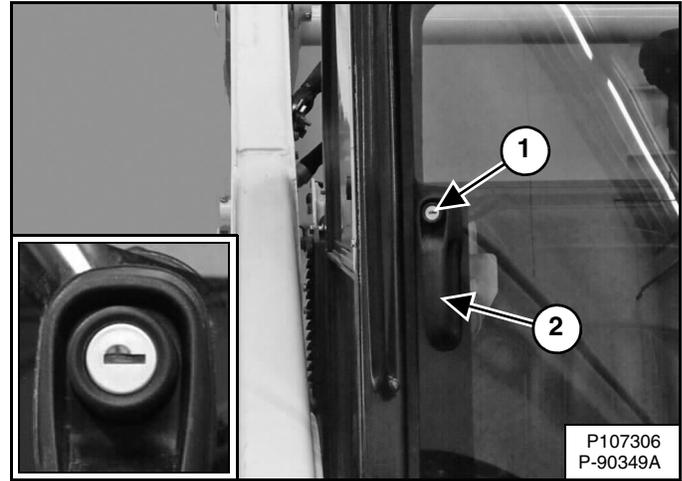
Empuje la perilla (ítem 1) y tire del mando (ítem 2) para abrir la puerta delantera. La perilla se suministra con un cerrojo (interior) [Figura 30] que asegura la puerta delantera cuando el cargador no está en uso.
