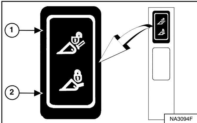
Empuje y sostenga el interruptor que “SUBE” LAS CUÑAS DEL BOB-TACH (ítem 1) hasta que suban del todo. Empuje y sostenga el interruptor que “BAJA” LAS CUÑAS DEL BOB-TACH” (ítem 2) [Figura 285] hasta que bajen del todo.
