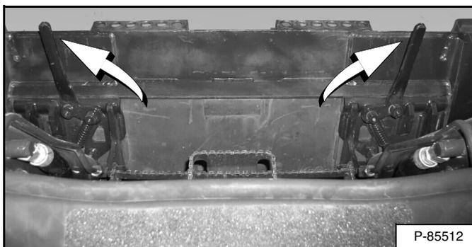
Tire de las palancas del Bob-Tach (enganche manual) hacia arriba [Figura 146] hasta que queden completamente levantadas (cuñas completamente levantadas).
