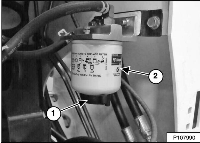
Afloje el desfogue (ítem 1) [Figura 213] del fondo del filtro para extraer el agua del filtro.
