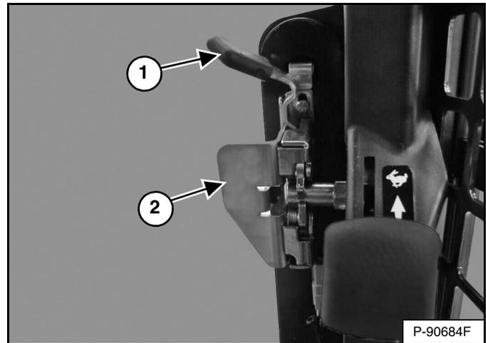
Tire de la puerta delantera con la palanca (ítem 2) [Figura 31].
