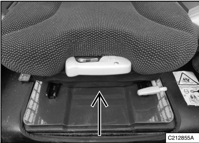
Mueva el asiento completamente hacia la parte trasera de la cabina del operador [Figura 183].
