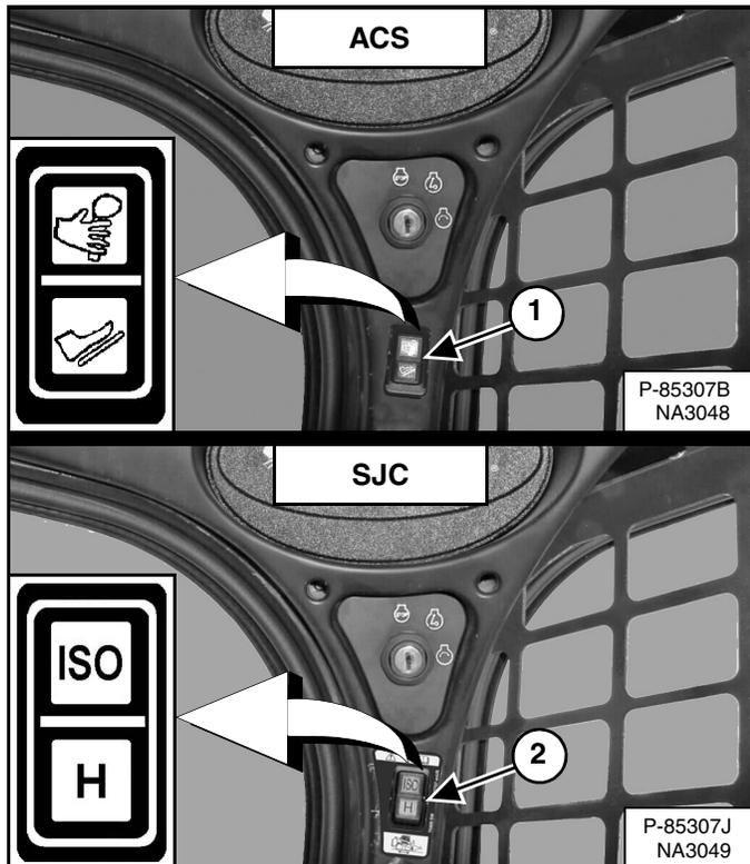
(ACS) Elija operar la máquina con controles de mano o pedales (ítem 1) [Figura 123] si la máquina dispone de ACS.
