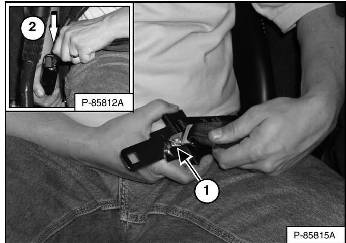
Conecte el cinturón de hombro con el cinturón de la cadera (ítem 1). Tire del cinturón de cadera hacia el lado derecho del asiento y abróchelo (ítem 2) [Figura 117].
