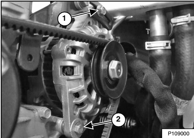
Aflove el perno de ajuste del alternador superior (ítem 1) y aflove el perno de fijación del alternador inferior (ítem 2) [Figura 258].
