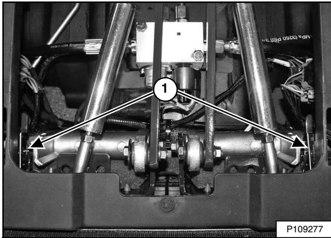
Los interruptores de la alarma de reversa (ítem 1) [Figura 178] están a lo largo de los balancines de la dirección. Ambos interruptores se deben graduar bien para que la alarma funcione correctamente.
