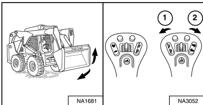
*Operación de inclinación – (joystick manual derecho)*
