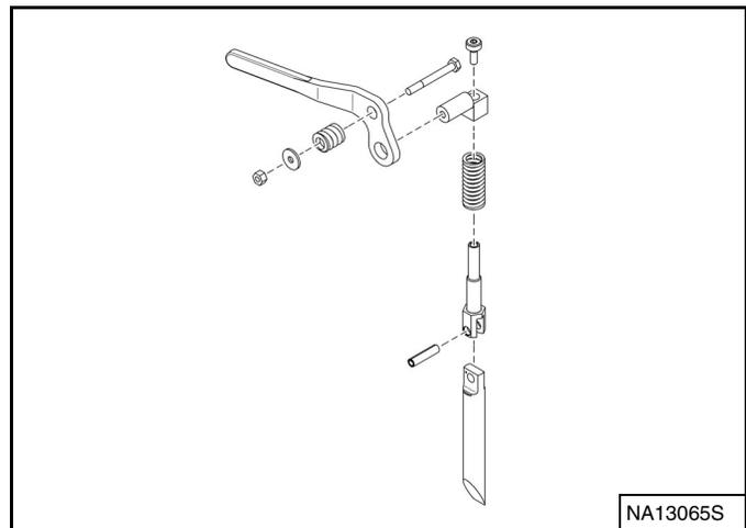
Inspeccione si el bastidor de fijación del aditamento y el enganche rápido (Bob-Tach), los acoplamientos y cuñas están excesivamente desgastados o dañados [Figura 287]. Reponga las partes que están dañadas, golpeadas o que faltan. Mantenga todos los sujetadores apretados.
