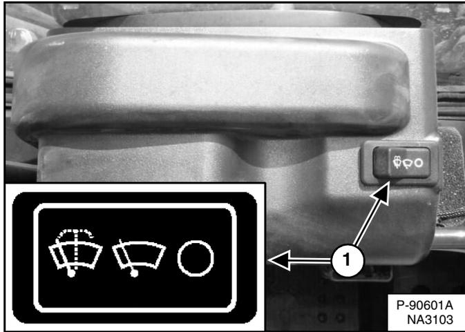
Oprima el lado izquierdo del interruptor (ítem 1) [Figura 32] para activar el limpiaparabrisas delantero (oprima y sostenga el mismo interruptor para líquido limpiador). Oprima el lado derecho del interruptor para detener el limpiaparabrisas.
