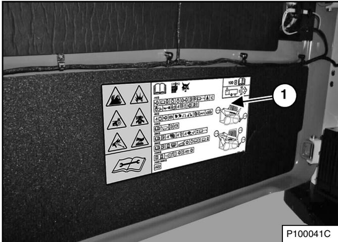
La lista de chequeo y mantenimiento (ítem 1) [Figura 107] está al interior de la compuerta trasera del cargador.
