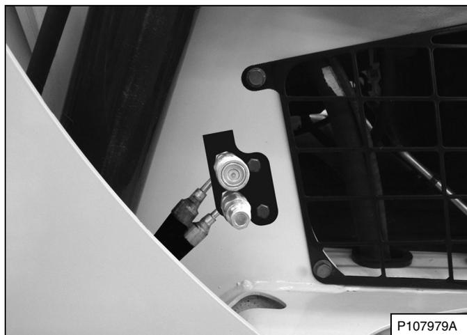
Mueva el interruptor de los hidráulicos auxiliares traseros (ítem 1) [Figura 95] o [Figura 96] hacia la derecha o izquierda para cambiar la dirección del caudal del fluido hidráulico auxiliar hacia los acoples rápidos traseros [Figura 97]. (POR EJEMPLO: subir y bajar estabilizadores traseros). Suelte el interruptor para detener el caudal del fluido.
