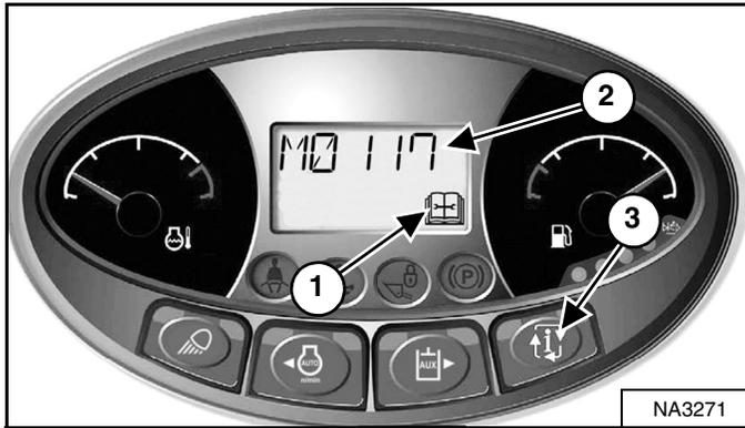
Reemplace los filtros de aire solo cuando sea necesario. El indicador de servicio (ítem 1) DESTELLA. Oprima el botón de información (ítem 3) hasta que la pantalla muestre los códigos de diagnóstico. El código [M0117] (filtro de aire tupido) aparece en la pantalla (ítem 2) [Figura 206] cuando el filtro de aire se debe cambiar.
