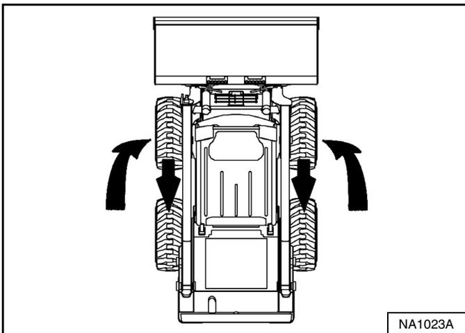
Las llantas traseras se desgastan generalmente más rápido que las delanteras. Para mantener un desgaste parejo, pase las llantas delanteras para atrás y las llantas traseras para adelante [Figura 254].
