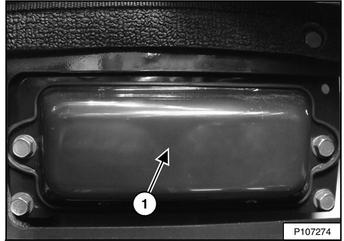
El sistema eléctrico está protegido de sobrecargas por los fusibles que están debajo de la cubierta del panel (ítem 1) [Figura 228].
