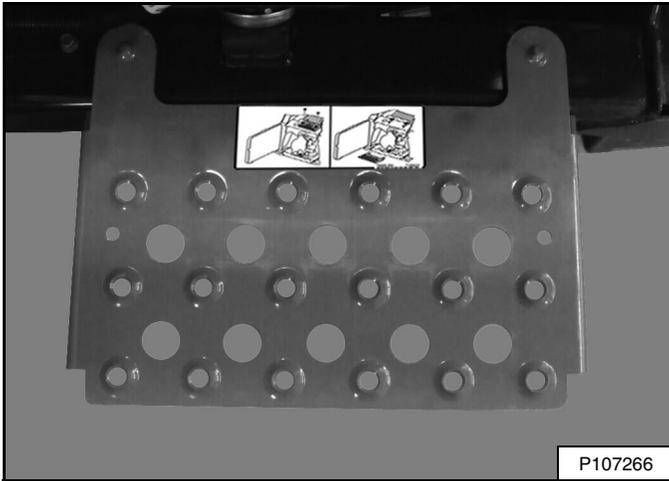
Hay una plataforma de mantenimiento [Figura 221] disponible donde su distribuidor Bobcat que facilita el acceso cuando se limpia el sistema de refrigeración del motor.
