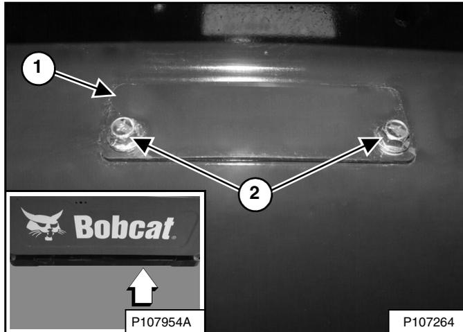
La manguera de drenaje de aceite está detrás de una tapa (ítem 1), debajo de la parte trasera del cargador (interior) [Figura 218].
