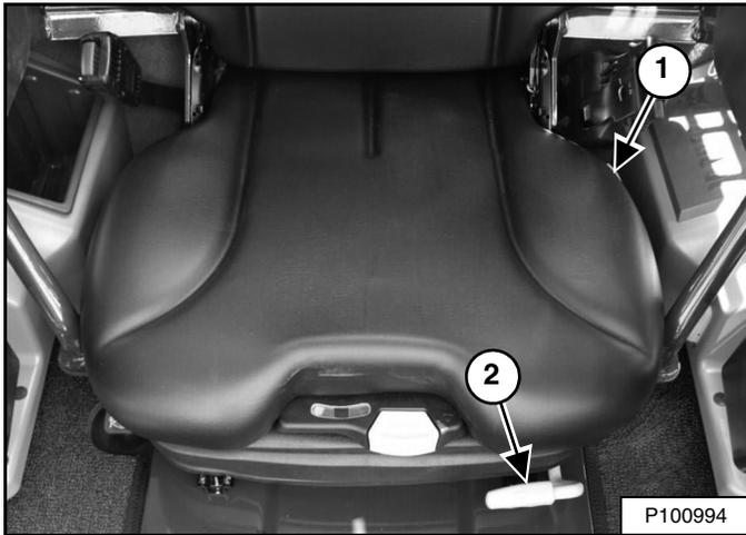
Tire de la palanca (ítem 1) [Figura 113] hacia arriba para ajustar el ángulo del espaldar del asiento.
