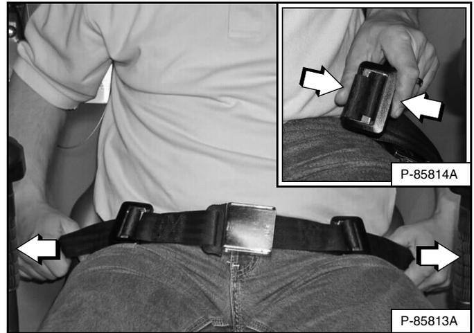
Apriete ambos ajustadores para soltar y alargar cada mitad del cinturón de seguridad (interior) [Figura 116].
