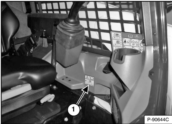
Inspeccione que la calcomanía de la alarma de alerta de reversa no esté dañada o falte (ítem 1) [Figura 176]. Repóngala, si es del caso.
