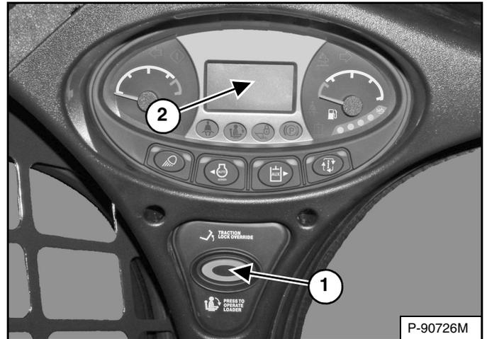
Oprima el botón PRESS TO OPERATE LOADER (ítem 1) [Figura 129] para activar el BICS<sup>MR</sup> y para usar las funciones hidráulicas y del cargador.
