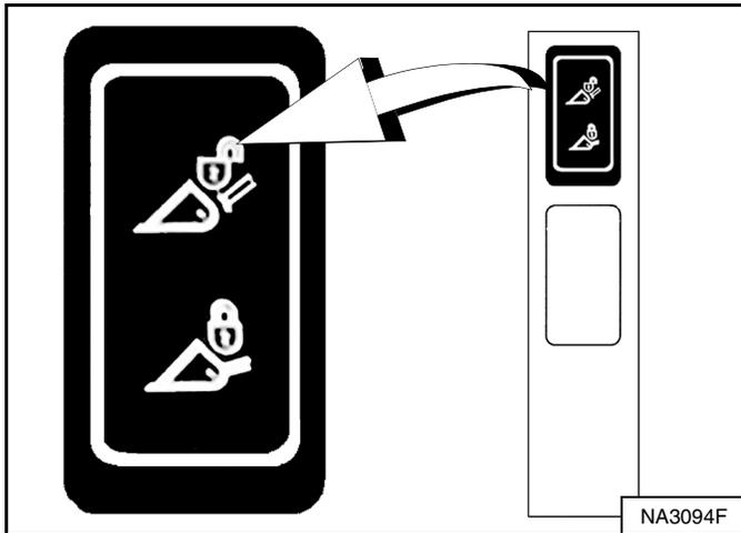
Empuje y sostenga el interruptor que “SUBE” LAS CUÑAS del BOB-TACH (en el panel de interruptores a mano derecha) [Figura 152] para asegurarse que las palancas están completamente levantadas (cuñas completamente arriba).
