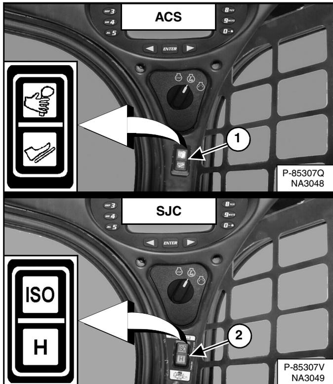
(ACS) Elija operar la máquina con controles de mano o pedales (ítem 1) [Figura 133] si la máquina dispone de ACS.
