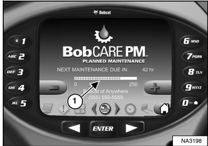
El panel de instrumentos de lujo (si está equipado) muestra una barra (ítem 1) [Figura 294] que muestra el tiempo restante para el siguiente servicio. Esta barra se vuelve roja cuando el servicio ya se debió haber hecho. La frase [NEXT MAINTENANCE DUE] (siguiente mantenimiento pendiente) se convierte en [MAINTENANCE PAST DUE] (mantenimiento en mora) y aparece el número de horas en mora.
