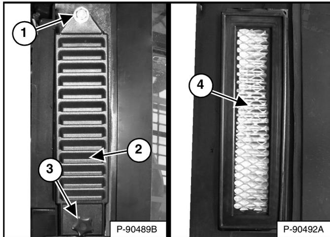
Los filtros de aire fresco se encuentran debajo de las ventanas laterales, por fuera de la cabina del operador. (Se muestra el filtro al lado derecho). Quite el tornillo de retención (ítem 3) y la tapa del filtro (ítem 2) [Figura 197]. (Los brazos de elevación se muestran levantados para describir el procedimiento con claridad).
