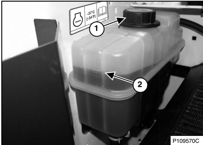
El refrigerante debe estar entre el indicador superior e inferior (ítem 2) [Figura 223] cuando el motor está frío.
