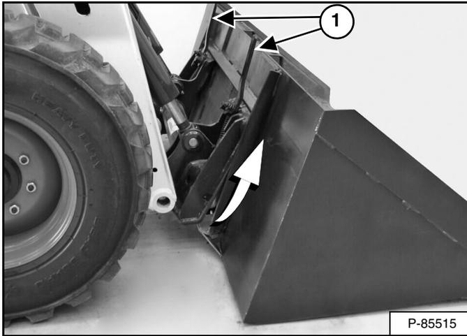
Tire de las palancas del Bob-Tach hacia arriba hasta que queden completamente levantadas (cuñas completamente levantadas) (ítem 1) [Figura 142].
