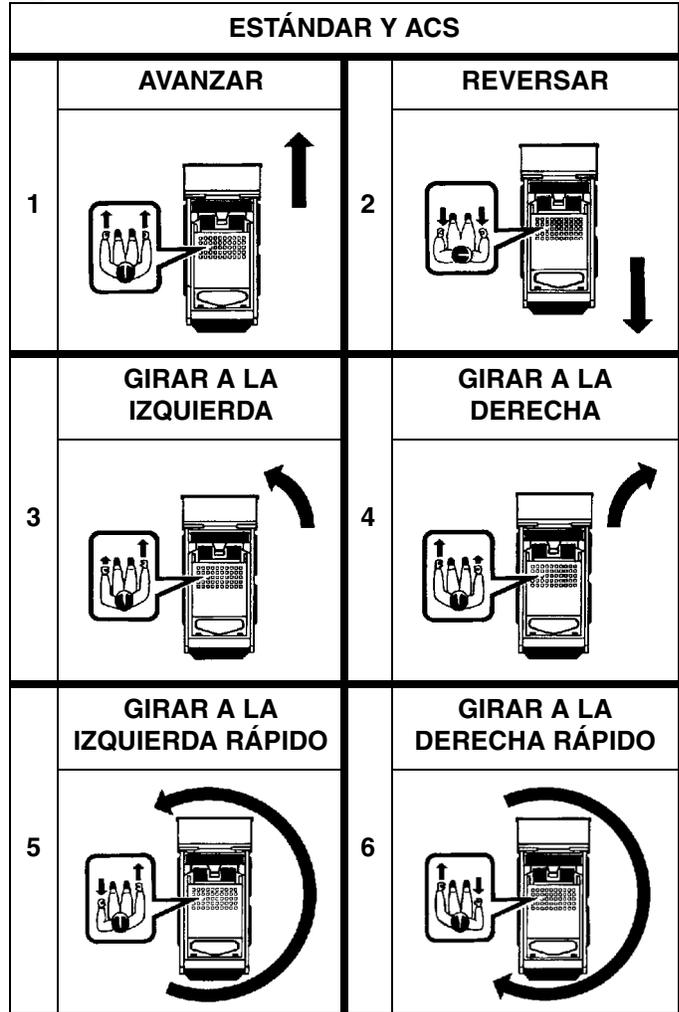
*Funciones de la palanca de dirección (manejo y dirección) [Figura 58]:*
