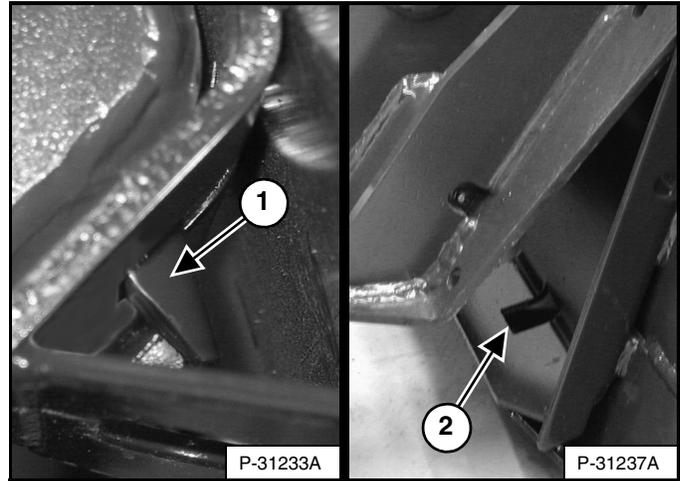
Las cuñas (ítem 1) deben atravesar los agujeros (ítem 2) [Figura 145] del bastidor de fijación del cucharón (u otro aditamento), asegurando con firmeza el cucharón al Bob-Tach.
