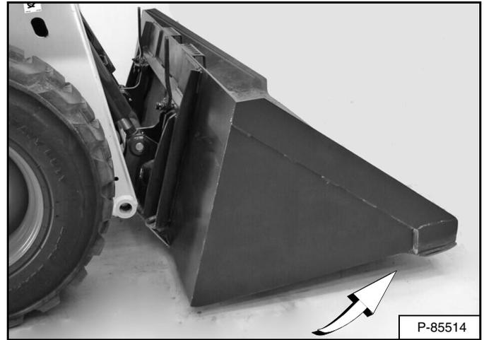
Incline el Power Bob-Tach hacia atrás hasta que el borde cortante del cucharón (u otro aditamento) quede un poco levantado del suelo [Figura 143]. Esto hace que el bastidor de fijación del cucharón se ajuste contra el frente del enganche rápido (Bob-Tach).
