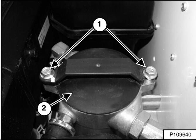
Afloje los pernos (ítem 1) y rote la tapa del filtro (ítem 2) [Figura 247] en sentido antihorario hasta que la tapa se libere de los pernos.
