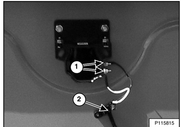
Inspeccione que las conexiones eléctricas (ítem 1) [Figura 177], arnés de cableado (ítem 2) [Figura 177] e interruptores (si están equipados) (ítem 1) [Figura 178] de la alarma está apretados y dañados. Repare o reponga los componentes dañados.
