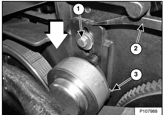
Empuje la polea tensora accionada con resortes contra la correa usando una barra (ítem 1). El indicador estará en posición de 90 grados (ítem 3) [Figura 266] cuando la polea tensora está contra el tope.
