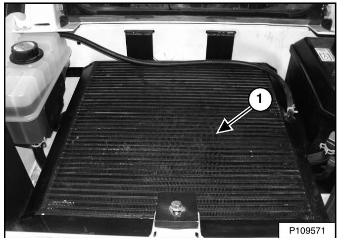
Use aire a baja presión para limpiar la parte superior del refrigerante del conjunto del líquido hidráulico y radiador (ítem 1) [Figura 222].
