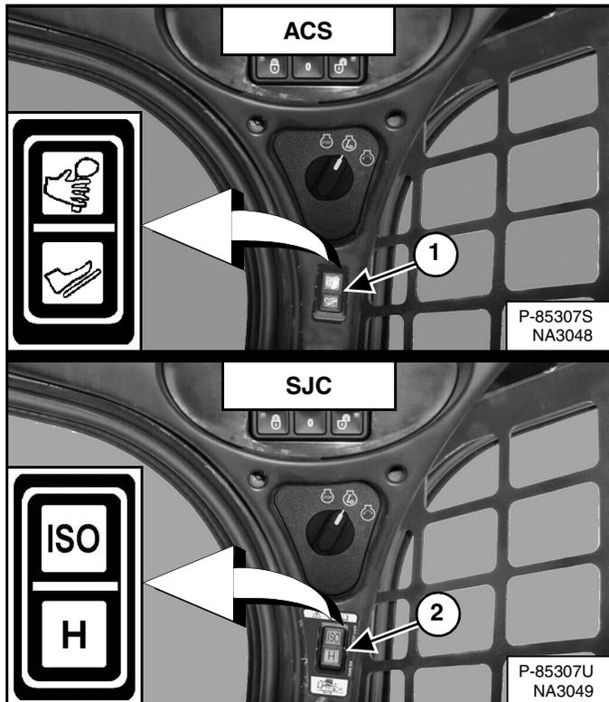
(ACS) Elija operar la máquina con controles de mano o pedales (ítem 1) [Figura 128] si la máquina dispone de ACS.
