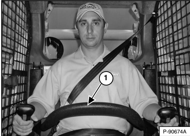
El sistema de restricción del asiento tiene una barra del asiento que hace pivote con descansabrazos (ítem 1) [Figura 167].
