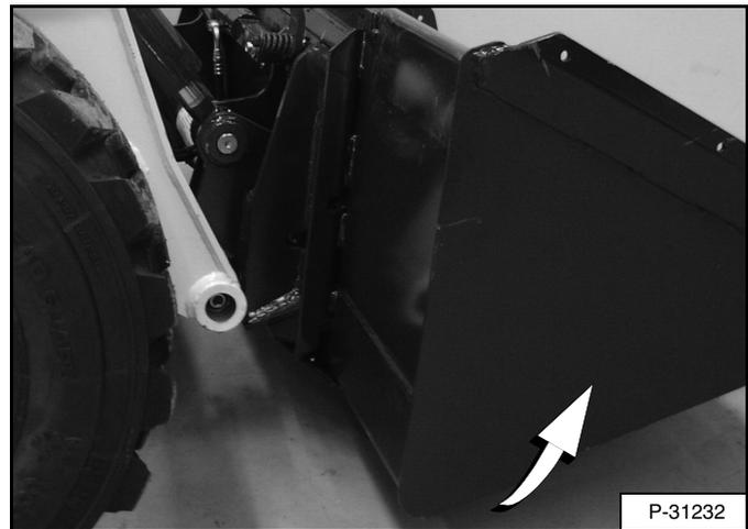
Incline el Power Bob-Tach hacia atrás hasta que el borde cortante del cucharón (u otro aditamento) quede un poco levantado del suelo [Figura 151]. Esto hace que el bastidor de fijación del cucharón se ajuste contra el frente del enganche rápido (Bob-Tach).
