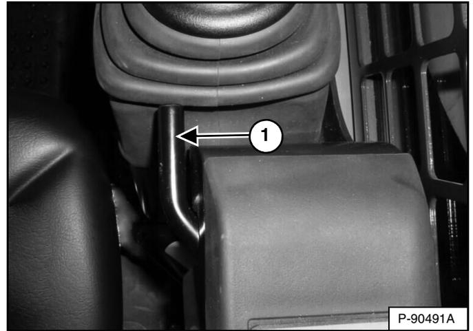
Para trabajar con comodidad, tire de la palanca de ajuste (ítem 1) [Figura 119] hacia arriba para deslizar los joysticks del cargador hacia adelante o atrás. (Se muestra el lado derecho).
