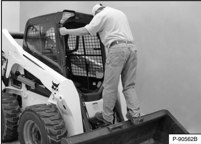
Use los escalas del cucharón o aditamento, las palancas de agarre y los peldaños de seguridad (en el brazo y el bastidor del cargador) para ingresar y salir del cargador, manteniendo 3 puntos de contacto todo el tiempo [Figura 108]. No salte.
