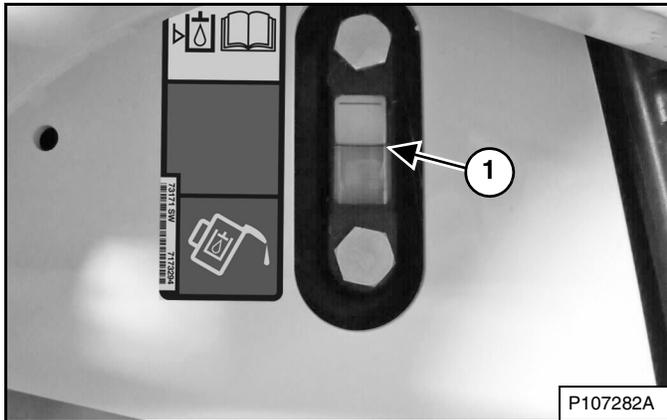
Revise el nivel de fluido en la ventanilla o indicador (ítem 1) [Figura 240]. Mantenga el nivel dentro del rango de operación.
