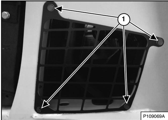
Quite los pernos de la cubierta de acceso a mano izquierda (ítem 1) [Figura 249] y quite la cubierta. (Los brazos de elevación se muestran levantados para describir el procedimiento con claridad).
