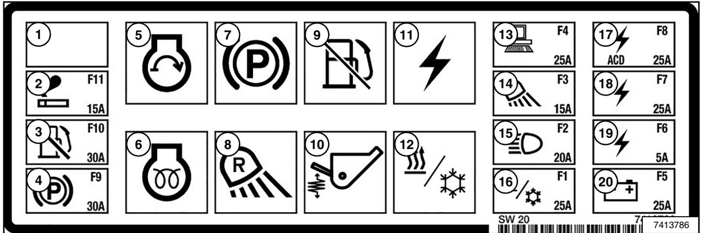
La siguiente tabla es para modelos con la calcomanía parte número 7413786. La ubicación y los niveles de amperios se muestran en la tabla de abajo y en la calcomanía [Figura 233]. Los relés o disyuntores se identifican con la letra “R” en la columna AMP.
