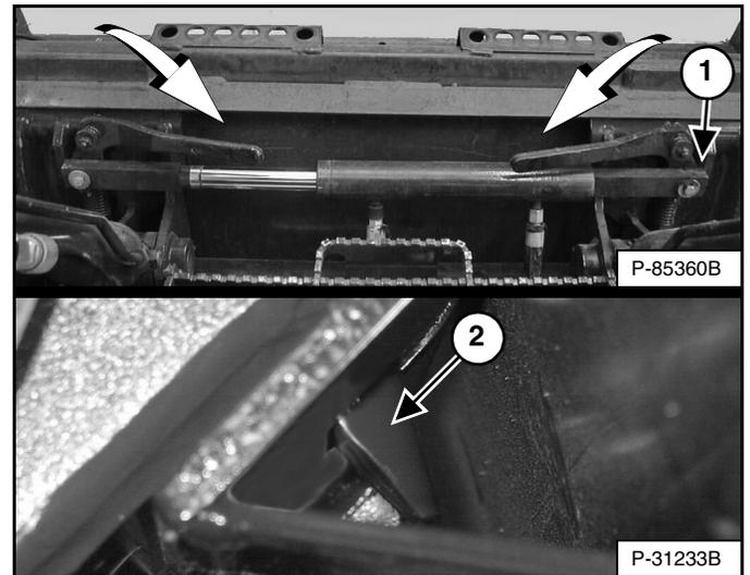
Empuje y sostenga el interruptor que “BAJA” LAS CUÑAS del BOB-TACH (en el panel de interruptores a mano derecha) [Figura 153] hasta que las palancas queden completamente enganchadas en posición asegurada [Figura 154] (las cuñas atraviesan del todo los agujeros del bastidor de fijación del aditamento).
