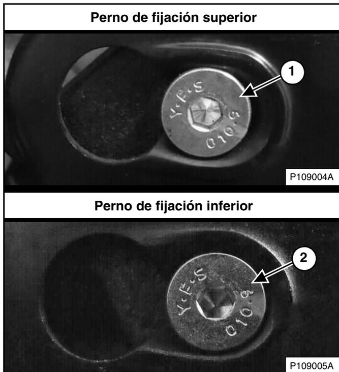
Coloque el protector de la correa de transmisión sobre los pernos de fijación y deslice el protector hacia el frente del cargador para sentar el protector completamente en los pernos de fijación superior e inferior (ítem 1 y 2) [Figura 267].
