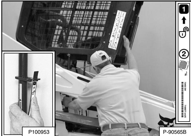
Tire hacia abajo el extremo inferior de la cabina del operador hasta que ésta se detenga en el mecanismo de seguridad [Figura 189].
