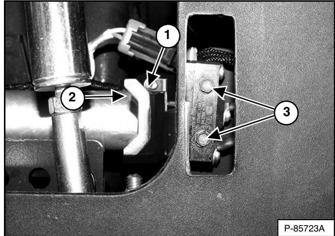
Afloje los tornillos (ítem 3) [Figura 179] que aseguran el interruptor de la alarma de reversa. (Se muestra el lado izquierdo).
