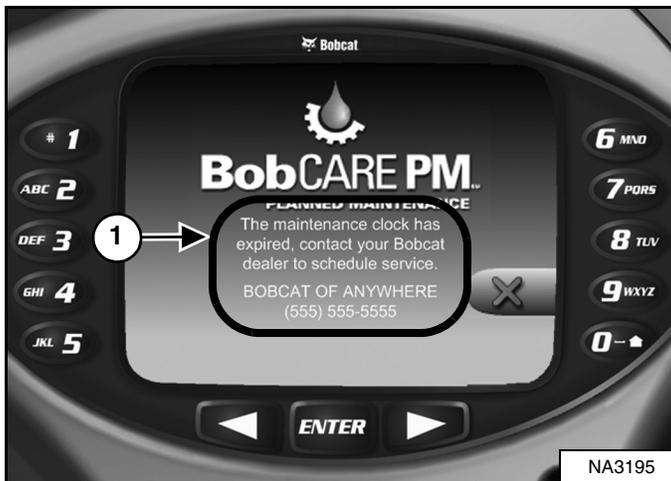
El panel de instrumentos de lujo (si está equipado) muestra un mensaje (ítem 1) [Figura 293] que alerta al operador dar servicio a la máquina.
