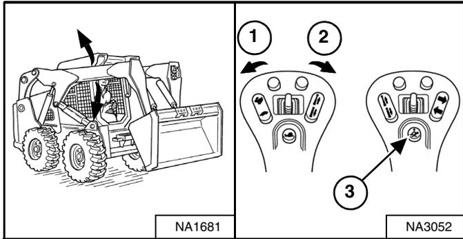
*Operación del brazo de elevación – (joystick manual izquierdo)*
