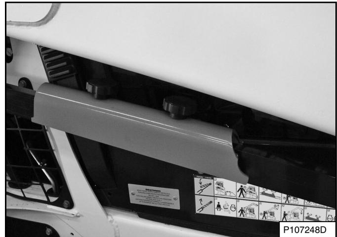
Regrese el soporte del brazo a la posición de almacenamiento y asegúrelo con perillas de sujeción [Figura 175].
