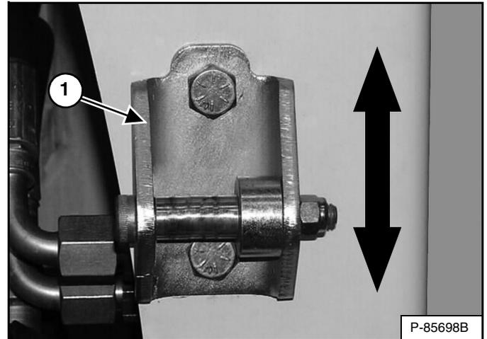
El cerrojo de la compuerta (ítem 1) [Figura 194] se puede ajustar hacia arriba o abajo para alinearlos con el cerrojo de la compuerta.
