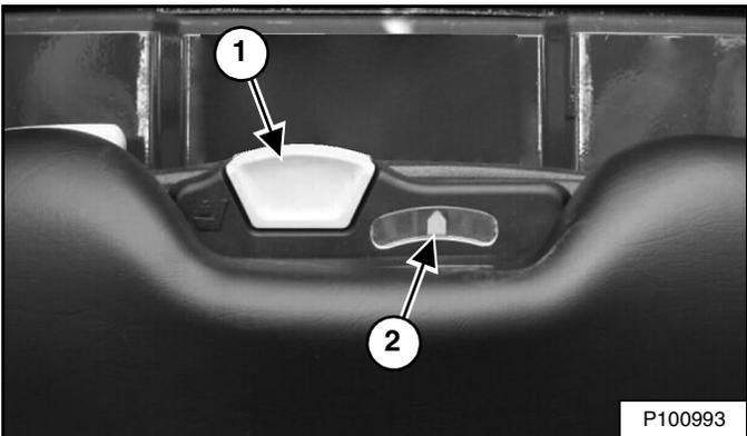
La palanca (ítem 1) se usa para ajustar la respuesta de la suspensión del asiento dependiendo del peso del operador. El ajuste óptimo se logra cuando la aguja (ítem 2) [Figura 114] está centrada en el medidor con el operador sentado normalmente.
