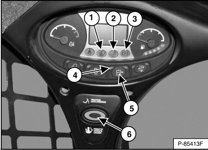
1. Siéntese en el asiento del operador. Gire el interruptor de llave a RUN. Baje la barra del asiento y libere el freno de parqueo. Oprima el botón PRESS TO OPERATE LOADER (ítem 6). Las dos luces del BICS<sup>MR</sup> (ítem 1 y 2) [Figura 166] [DE BARRA DEL ASIENTO y VÁLVULA DE ELEVACIÓN E INCLINACIÓN] en el panel de instrumentos izquierdo deben estar APAGADAS. El botón de PRESS TO OPERATE LOADER se enciende.
