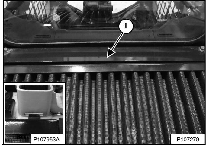
Alinee el borde de la rejilla posterior debajo del protector (ítem 1), inserte las lengüetas en las ranuras (se muestra el lado derecho) (interno) [Figura 196], y descienda.
