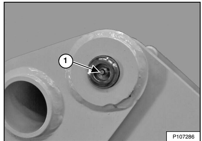
1. Pin de pivote del brazo de elevación (ambos lados) (2) [Figura 270].
