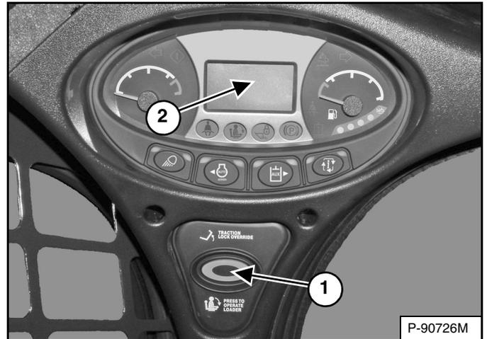
Oprima el botón PRESS TO OPERATE LOADER (ítem 1) [Figura 134] para activar el BICS<sup>MR</sup> y para usar las funciones hidráulicas y del cargador.
