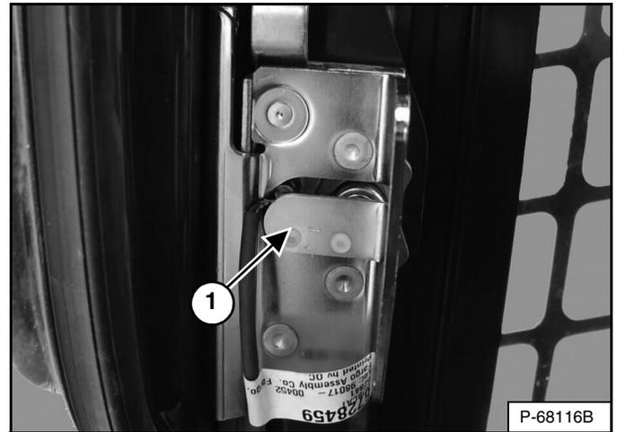
La puerta de la cabina tiene un sensor (ítem 1) [Figura 180] instalado, el cual desactiva las válvulas de elevación e inclinación cuando la puerta está abierta.
