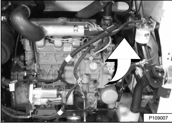
El alternador está detrás del motor al lado derecho del cargador [Figura 257].
