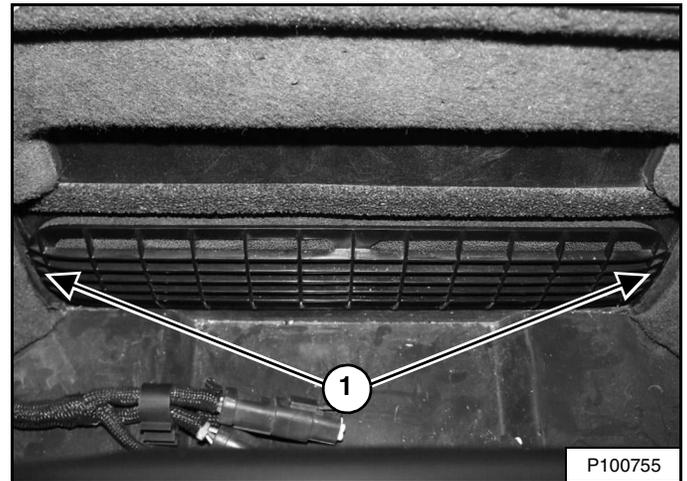
El filtro de recirculación está detrás del asiento del operador, dentro de la cabina. La tapa del filtro se mantiene en su posición con tres ganchos. Tire de cada punta de la tapa (ítem 1) [Figura 198] para quitarla.
