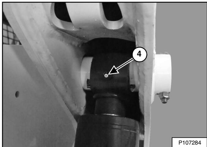
4. Punta de la biela del cilindro de elevación (ambos lados) (2) [Figura 273].
