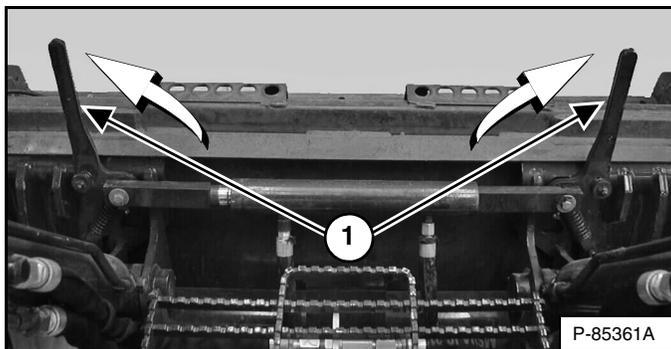
Empuje y sostenga el interruptor que “SUBE” LAS CUÑAS del BOB-TACH (en el panel de interruptores a mano derecha) [Figura 148] hasta que las palancas (ítem 1) [Figura 149] queden arriba del todo (cuñas completamente levantadas).
