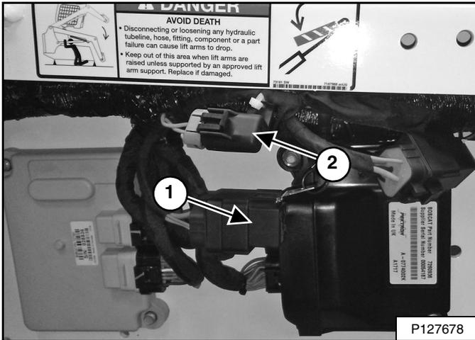
El relé (ítem 1) [Figura 234] del asiento calentado está debajo de la cabina del operador, al lado izquierdo del cargador. El relé generalmente está encima del arnés. Detenga el motor y suba la cabina del operador para tener acceso al relé. (Ver Cómo subir la cabina en la página 136).
