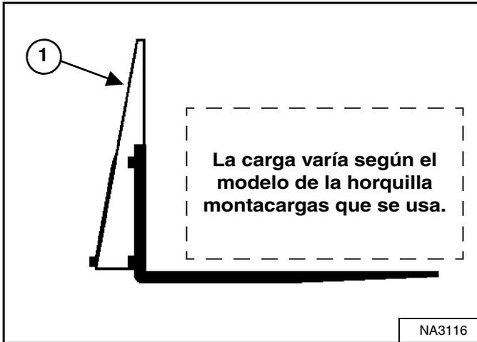
La máxima carga a transportar cuando se usa una horquilla montacargas se muestra en una calcomanía ubicada en el bastidor de dicha horquilla montacargas (ítem 1) [Figura 141].
