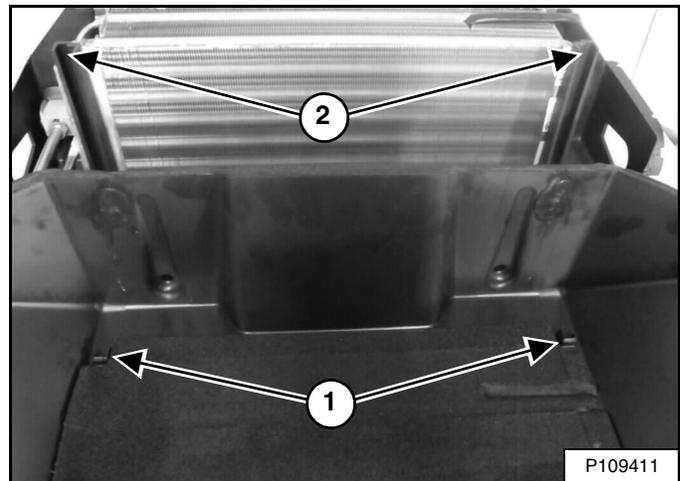
1. Los bujes (ítem 1) caben dentro de los soportes (ítem 2) [Figura 202] cuando la cubierta está instalada. Una cubierta deforme indica que no están bien colocados.
