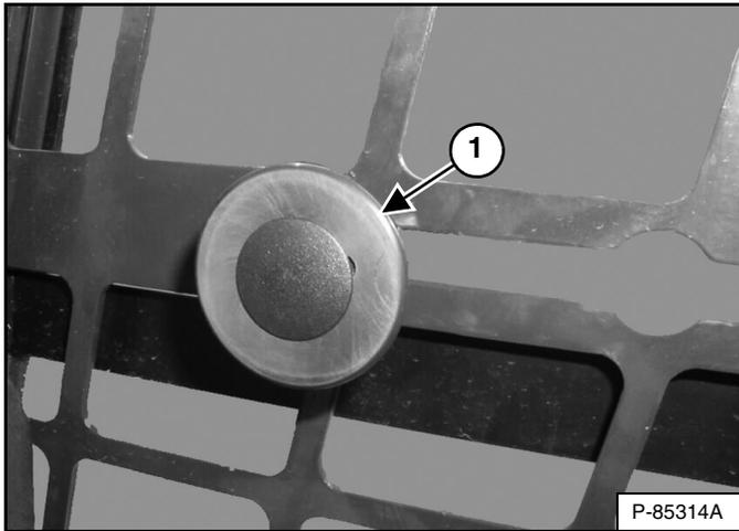
Tire de la perilla (ítem 1) [Figura 29] y deslícela hacia atrás para abrir la ventana. Suelte la perilla para asegurarla en la posición deseada. Tire de la perilla y deslícela hacia adelante para cerrar la ventana.
