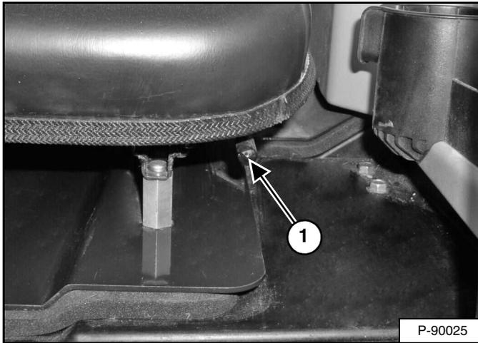
Tire de la palanca (ítem 1) [Figura 110] hacia afuera para ajustar la posición del asiento para operar los controles del cargador con comodidad.
