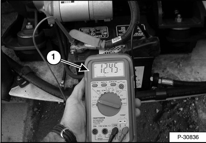
La manera más sencilla y común para determinar la carga de una batería es con un multímetro o voltímetro digital (ítem 1) [Figura 236].
