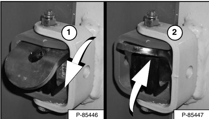
Mueva la traba de la compuerta a la posición enganchada (ítem 1) para mantener la compuerta abierta. Mueva la traba hacia arriba (ítem 2) [Figura 193] para permitir que la compuerta se cierre.
