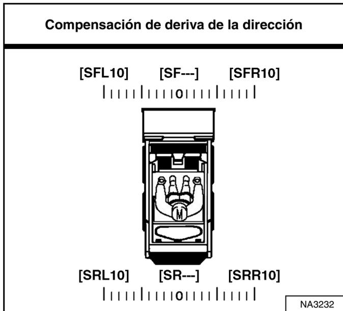
La compensación de deriva de la dirección contiene 21 ajustes. La compensación de deriva de la dirección se puede ajustar en cualquier punto, desde la posición NEUTRAL hacia la izquierda [SFL10] o [SRL10], y desde la posición NEUTRAL hacia la derecha [SFR10] o [SRR10]. El texto [SF---] o [SR---] aparece en la pantalla cuando se configura para la posición NEUTRAL [Figura 73].
