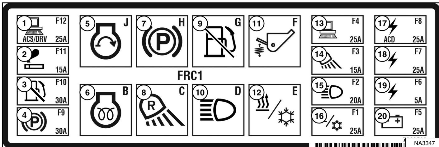
La siguiente tabla es para modelos con la calcomanía parte número 7323562. La ubicación y los niveles de amperios se muestran en la tabla de abajo y en la calcomanía [Figura 231]. Los relés o disyuntores se identifican con la letra “R” en la columna AMP.
