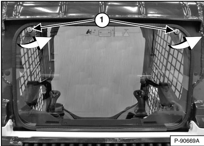
La ventana posterior se puede quitar por fuera del cargador usando una herramienta motriz T40 TORX®. Voltee ambos tornillos (ítem 1) [Figura 48] en sentido antihorario hasta que los cerrojos se liberen del marco de la ventana. Tire de la parte superior de la ventana hacia arriba alejándola de la cabina y levántela para quitarla.
