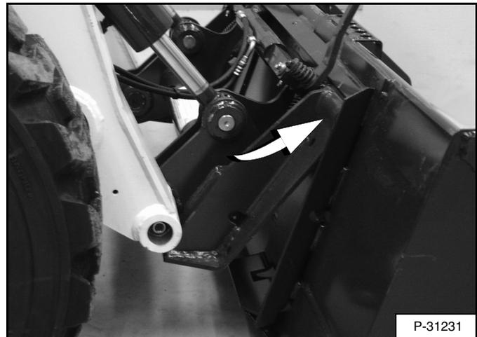
Maneje el cargador lentamente hacia adelante hasta que el borde superior del Bob-Tach quede completamente debajo de la pestaña superior del bastidor de fijación del cucharón [Figura 150] (o de otro aditamento).
