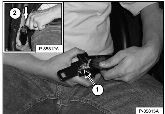
**NOTA: Se debe usar la restricción de 3 puntos cuando elija operar en rango alto [Figura 65].**
