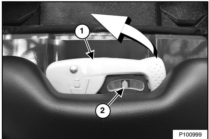
La palanca (ítem 1) se usa para ajustar la respuesta de la suspensión del asiento dependiendo del peso del operador. El ajuste óptimo se logra cuando la aguja (ítem 2) [Figura 112] está centrada en el medidor con el operador sentado normalmente.
