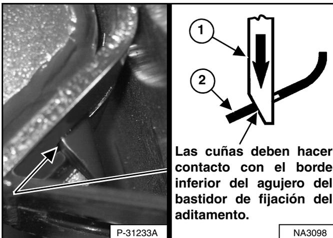
Las cuñas deben hacer contacto con el borde inferior del agujero del bastidor de fijación del aditamento.
