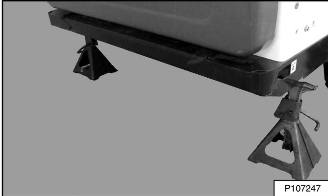
Instale los soportes debajo del extremo posterior del bastidor del cargador [Figura 182].
