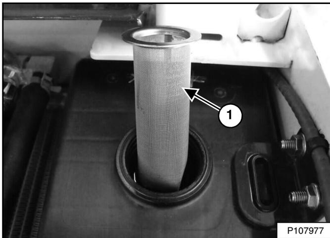
Quite y limpie la pantalla de llenado hidráulico (ítem 1) [Figura 246]. Use aire a presión baja para secar la pantalla.
