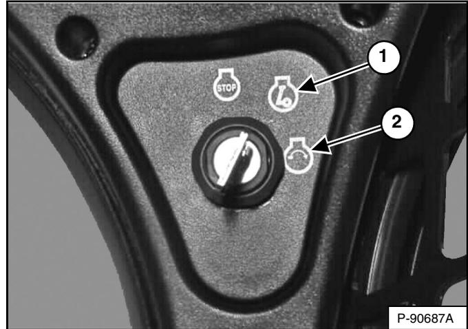
Gire el interruptor a RUN (ítem 1) [Figura 121]. Las luces indicadoras en el panel de instrumentos izquierdo se ENCENDERÁN brevemente y el panel de instrumentos / sistema de monitoreo realizará una autoprueba.
