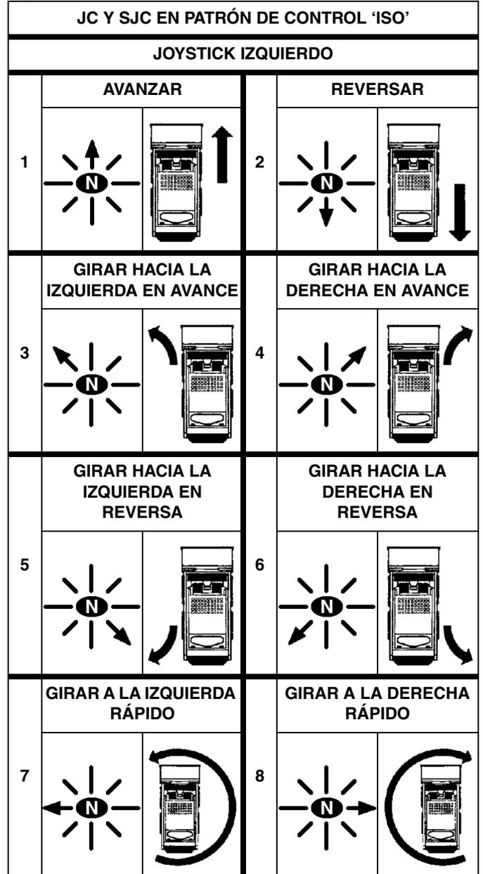
Funciones del joystick izquierdo (manejo y dirección) [Figura 61]:
