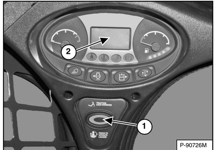
Oprima el botón PRESS TO OPERATE LOADER (ítem 1) [Figura 124] para activar el BICS<sup>MR</sup> y para usar las funciones hidráulicas y del cargador.
