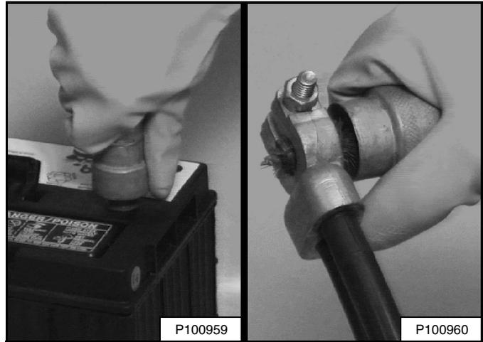
Limpie siempre los bornes y puntas de los cables cuando instale una batería nueva o usada [Figura 239].
