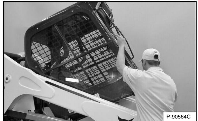
Suba las palancas de agarre y el extremo inferior de la cabina del operador [Figura 188] lentamente hasta que la cabina quede completamente arriba y el mecanismo de seguridad se enganche.
