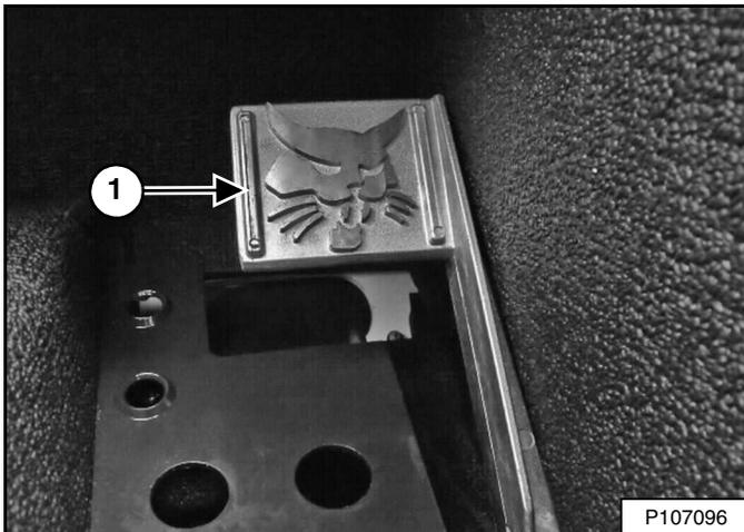
Las máquinas que disponen de joystick tienen un pedal de control (ítem 1) [Figura 41] y una palanca de control de velocidad del motor. El pedal está en el piso a mano derecha, sobre el descansapies.
