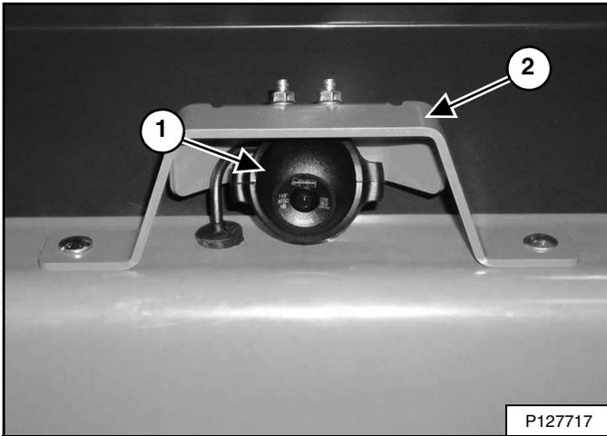
La cámara trasera (ítem 1) está dentro de una abrazadera (ítem 2) [Figura 23] montada en la parte superior de la compuerta trasera.
