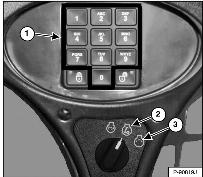
Gire el interruptor a RUN (ítem 2) [Figura 126]. Las luces indicadoras en el panel de instrumentos izquierdo se ENCENDERÁN brevemente y el panel de instrumentos / sistema de monitoreo realizará una autoprueba.
