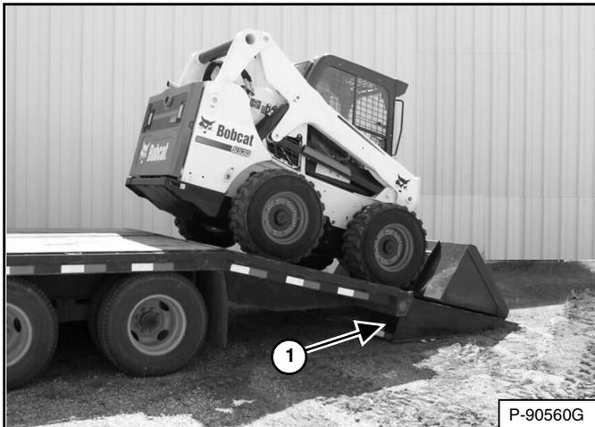
Un cargador con un cucharón vacío o sin aditamento debe cargarse en reversa sobre el vehículo de transporte [Figura 164].
