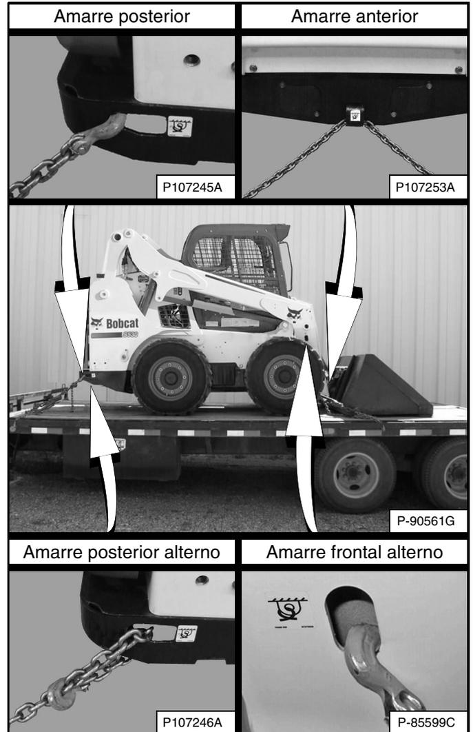
Ejecute el siguiente procedimiento para sujetar el cargador Bobcat al vehículo de transporte con el fin de evitar que el cargador se mueva durante paros repentinos o al subir o bajar pendientes [Figura 165].
