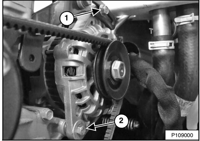
Aflove el perno de fijación del alternador inferior (ítem 2) y quite el perno de ajuste del alternador superior (ítem 1) [Figura 259].
