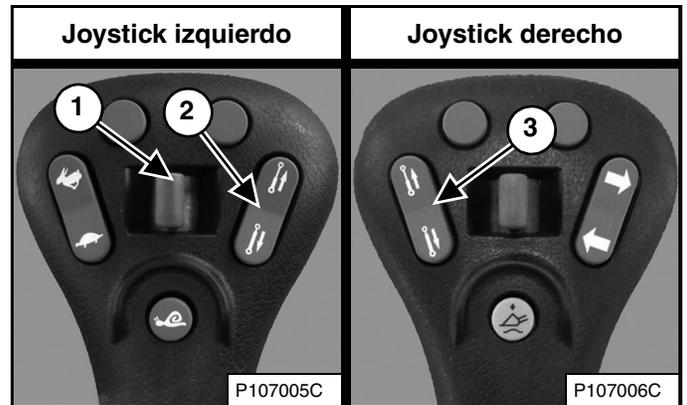
Los interruptores adicionales (ítem 1, 2 y 3) [Figura 105] o [Figura 106] se usan para controlar algunas funciones de los aditamentos a través del dispositivo de control.
