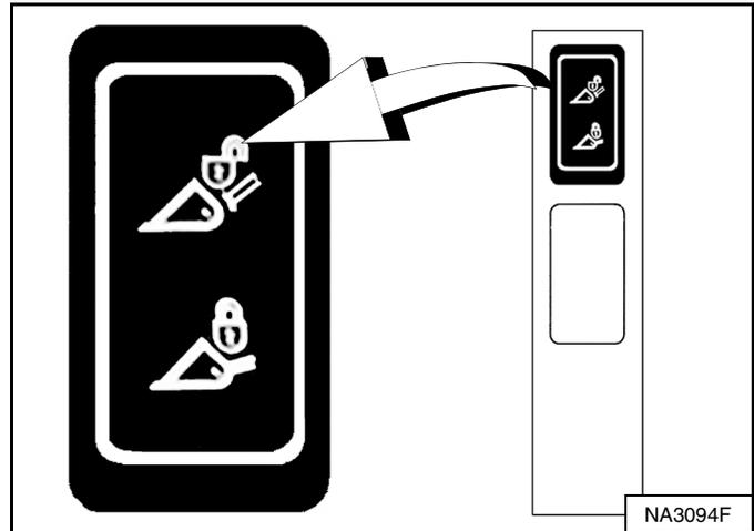
Oprima y sostenga el interruptor que “SUBE” LAS CUÑAS del BOB-TACH (en el panel de interruptores a mano derecha) [Figura 155] hasta que las palancas queden arriba del todo (cuñas completamente levantadas).
