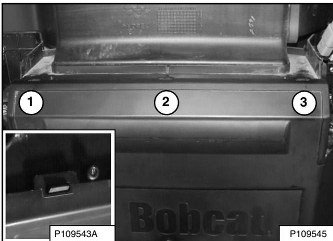
3. Empuje la cubierta hacia arriba tres lugares (ítem 1, 2 y 3) hasta que las ranuras se encajen en su lugar. Esta ranura (interior) [Figura 204] está ajustada correctamente.
