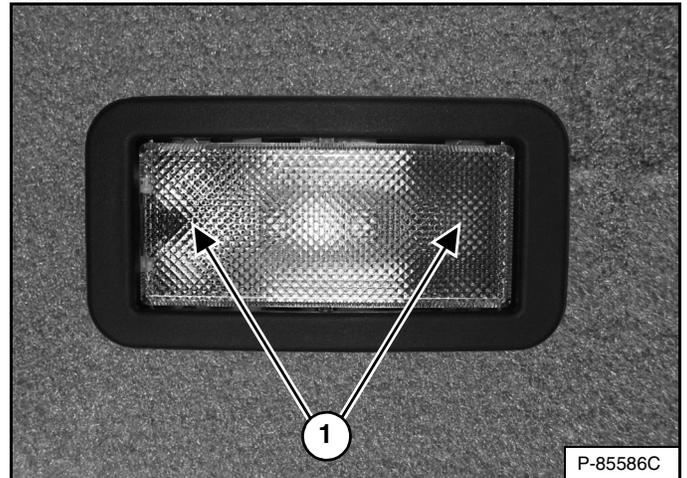
Empuje cualquier lado de los lentes (ítem 1) [Figura 34] para encender la lámpara. Coloque los lentes en posición central para apagar la lámpara.
