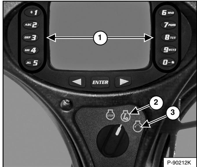
Gire el interruptor a RUN (ítem 2) [Figura 131]. Las luces indicadoras en el panel de instrumentos izquierdo se ENCENDERÁN brevemente y el panel de instrumentos / sistema de monitoreo realizará una autoprueba.
