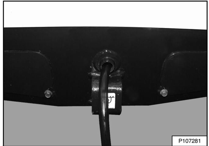
Bombee el fluido quitándolo de la caja de la cadena [Figura 256]. (Los brazos de elevación se muestran levantados para describir el procedimiento con claridad).
