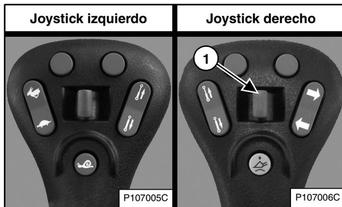
Mueva el interruptor de los hidráulicos auxiliares delanteros (ítem 1) [Figura 90] o [Figura 91] hacia la derecha o izquierda para cambiar la dirección del caudal del fluido hidráulico auxiliar hacia los acoples rápidos delanteros. Si mueve el interruptor hacia la mitad, las funciones auxiliares se mueven aproximadamente a media velocidad. (POR EJEMPLO: abrir y cerrar dientes de grapa).
