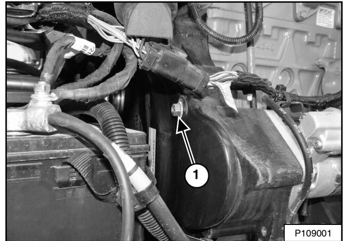
Instale el perno del protector de la correa de transmisión (ítem 1) [Figura 268].
