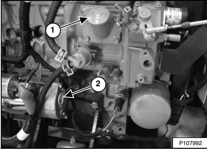
Estacione el cargador en una superficie llana. Detenga el motor. Abra la compuerta trasera y quite el medidor (ítem 2) [Figura 216].
