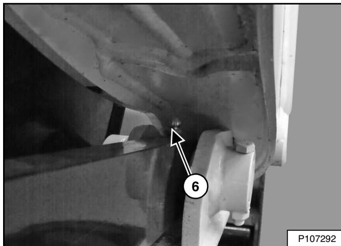
6. Acoplamiento de control delantero (ambos lados) (2) [Figura 275].
