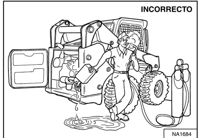
Use un recipiente limpio y aprobado para agregar el combustible especificado. Solo abastezca el tanque en un área que tenga un movimiento libre de aire y sin llamas abiertas o chispas. **NO FUME** [Figura 212].
