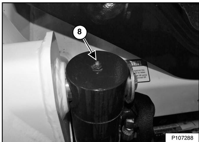
8. Punta de la base del cilindro de inclinación (ambos lados) (2) [Figura 277].
