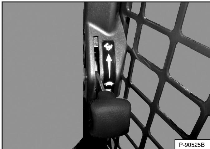
Coloque el control del motor en la posición de velocidad en ralentí baja (vacío) [Figura 137].
