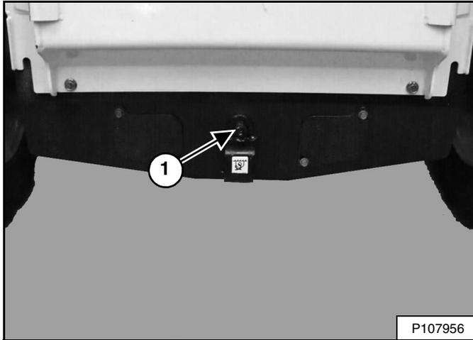
Quite el tapón regulador (ítem 1) [Figura 255] del frente de la carcasa de la caja de la cadena. (Los brazos de elevación se muestran levantados para describir el procedimiento con claridad).
