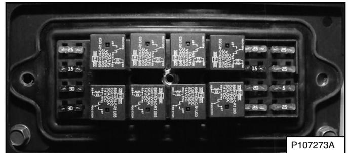
Quite la cubierta para revisar o cambiar los fusibles y relés [Figura 229].
