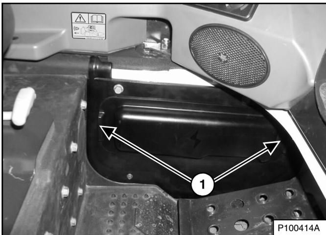
El panel de fusible / relé está detrás de un tablero de acceso cerca del pedal / descansa pies izquierdo. Tire de cada punta del panel (ítem 1) [Figura 227] para quitarlo.
