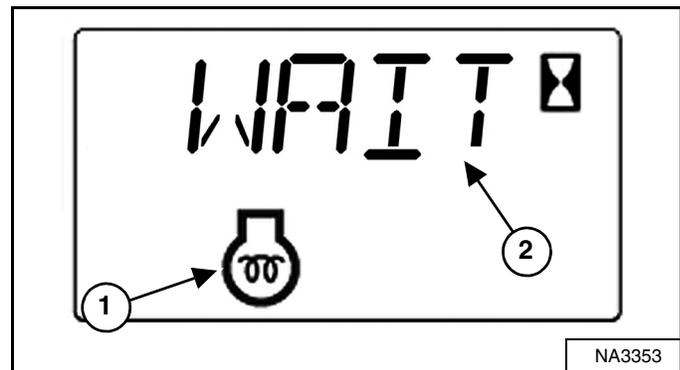
La máquina activa las bujías precalentadoras automáticamente con base en la temperatura. El ícono de precalentamiento del motor (ítem 1) y el tiempo restante del ciclo o [WAIT] (ítem 2) [Figura 122] aparece en la pantalla de datos.
