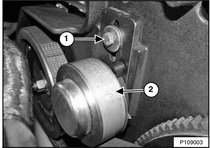
Afloje el perno de fijación (ítem 1) y permita que la polea tensora (ítem 2) [Figura 265] se mueva hacia arriba. Quite el conjunto del perno de fijación, arandela y polea tensora.
