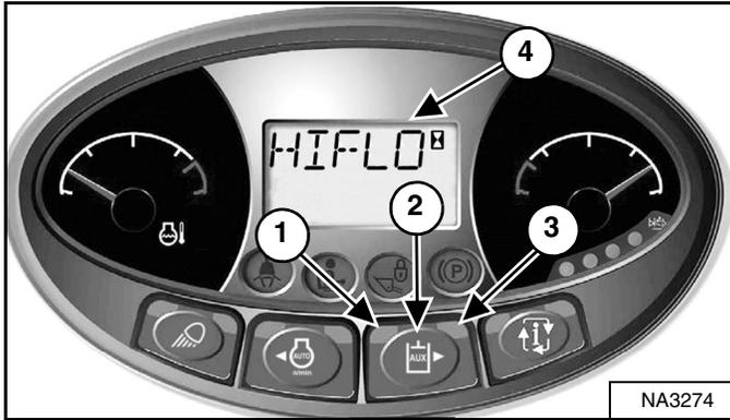
Oprima el botón (ítem 2) una vez para activar los hidráulicos auxiliares. La lámpara (ítem 1) **[Figura 98]** se ENCIENDE.
