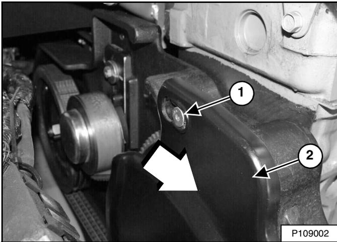
**NO** afloje los pernos del protector de la correa de transmisión (se muestra el perno superior) (ítem 1). Deslice el protector (ítem 2) [Figura 264] hacia el lado posterior del cargador para desasentarlo de los pernos de fijación superior e inferior de la correa.
