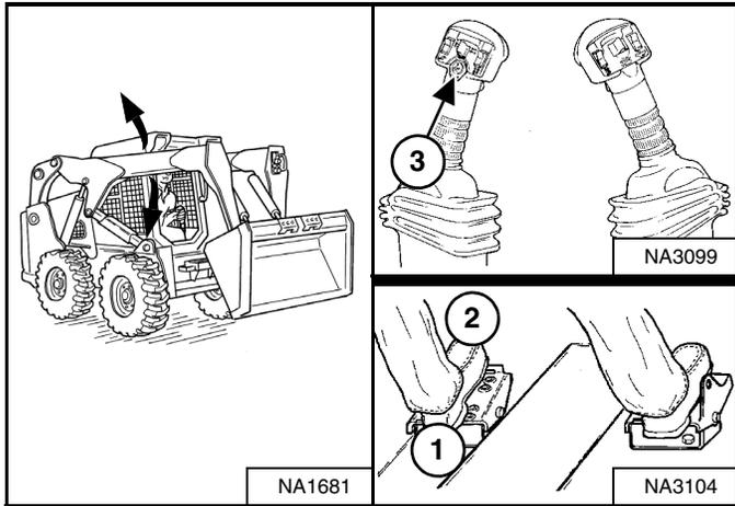
*Colocación del brazo de elevación en posición flotante (con ACS) – (pedal y mando izquierdo)*
