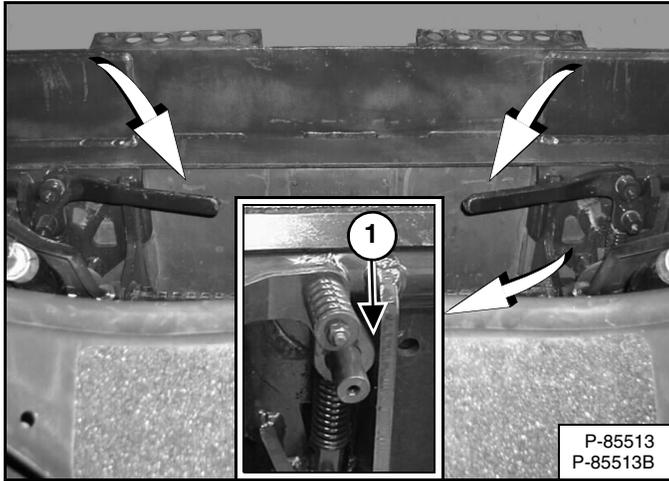
Empuje las palancas del Bob-Tach hacia abajo hasta que queden completamente en la posición asegurada [Figura 144] (las cuñas atraviesan completamente los agujeros del bastidor de fijación del aditamento).
