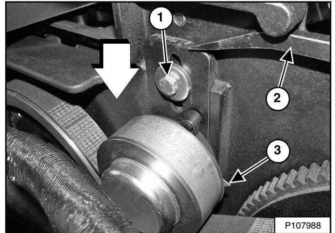
Afloje el perno de fijación de la polea tensora accionada con resorte (ítem 1) [Figura 262].
