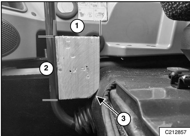
Las dimensiones para hacer el bloque son 95 mm (3.75 pulgadas) (ítem 1) por 140 mm (5.5 pulgadas) (ítem 2) por 75 mm (3.0 pulgadas). Recortar un poco el ángulo de esta esquina (ítem 3) [Figura 186] permite que el bloque se encaje correctamente.
