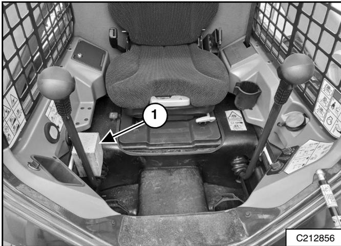
Mueva ambas palancas de dirección hacia el frente de la cabina del operador e instale un bloque (ítem 1) [Figura 185] para sostenerlas. Solo un bloque es requerido para sostenerlas.
