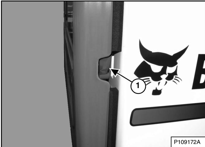
Alcance dentro de la ranura al lado derecho de la compuerta trasera y tire del mando de seguridad (ítem 1) [Figura 192]. Empuje la compuerta para abrirla.
