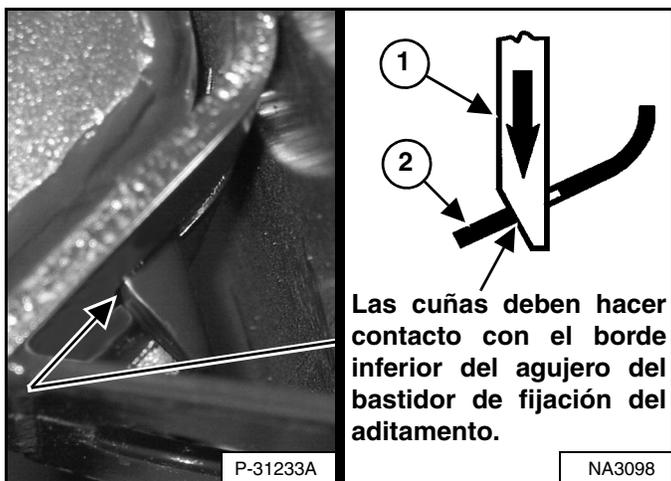
Las cuñas (ítem 1) [Figura 286] deben atravesar los agujeros en el bastidor de fijación del aditamento.
