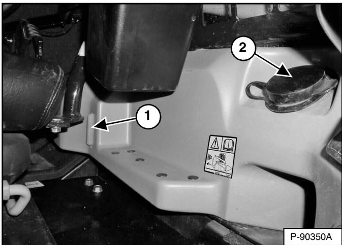
El tanque del líquido limpiador está al lado izquierdo del asiento del operador. Revise el nivel de líquido en el indicador (ítem 1). Quite la tapa (ítem 2) [Figura 33] para agregar líquido limpiador.
