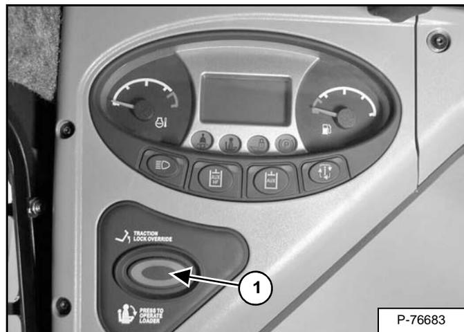
Oprima el botón PRESS TO OPERATE LOADER (ítem 1) [Figura OI-80] para activar el BICSMR y para ejecutar las funciones hidráulicas y del cargador.
