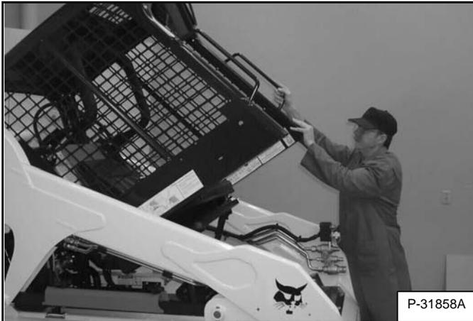
Suba las palancas de agarre y el extremo inferior de la cabina del operador [Figura PM-12] lentamente hasta que la cabina quede totalmente arriba y el mecanismo de de seguridad se enganche.
