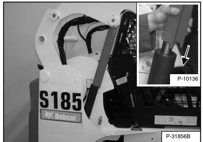
Baje el brazo lentamente hasta que el dispositivo de soporte se sostenga entre el brazo y el cilindro de elevación [Figura PM-6]. Las lengüetas del dispositivo de soporte del brazo deben atravesar la punta del cilindro (interior) [Figura PM-6].
