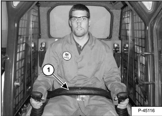
El Sistema de Enclavamiento de Controles Bobcat (BICS) tiene una barra del asiento que hace pivote con descansa brazos (ítem 1) [Figura OI-13]. El operador controla el uso de la barra del asiento.
