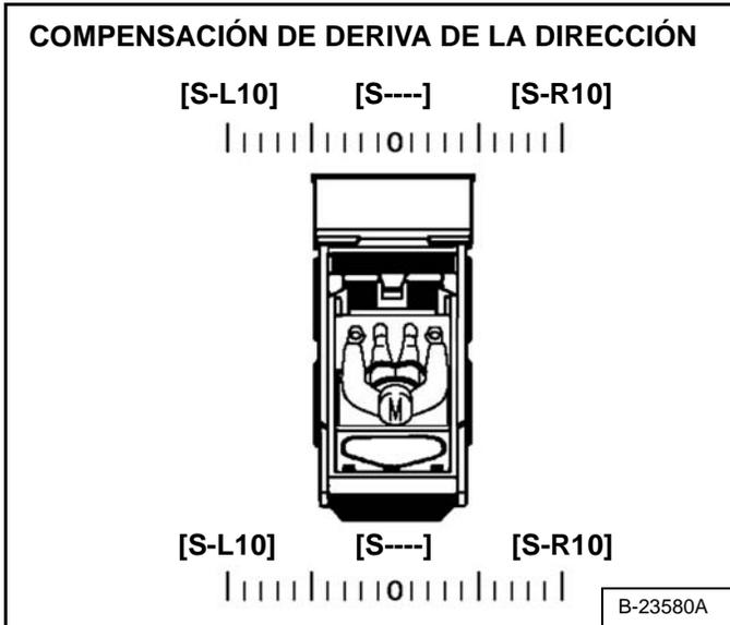
La compensación de deriva de la dirección contiene un total de 21 configuraciones. Este sistema se puede configurar en cualquier punto desde neutro hasta [S-L10] izquierdo y desde neutro hasta [S-R10] derecho. El texto [S----] aparece cuando se configura para neutro [Figura OI-35].
