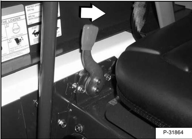
Coloque el control del motor en la posición de velocidad en ralentí (vacío) [Figura OI-76].
