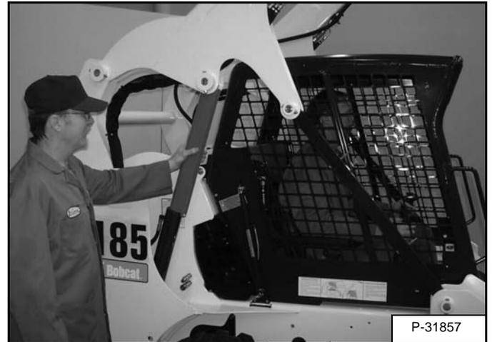
Una segunda persona debe instalar el dispositivo de soporte del brazo elevador sobre la varilla de uno de los cilindros de elevación [Figura PM-5].
