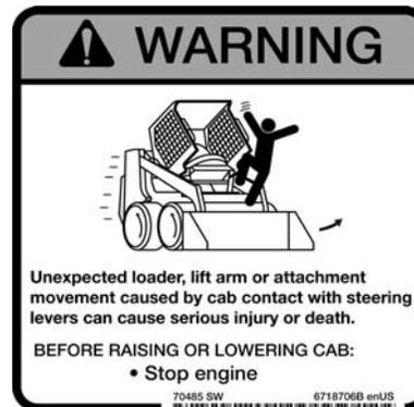
**NOTA:** En las máquinas equipadas con el Sistema de Control Avanzado (ACS), las palancas de dirección pueden hacer contacto con el bastidor de la cabina mientras sube o baja la cabina. El motor DEBE ESTAR detenido antes de subir o bajar la cabina.
