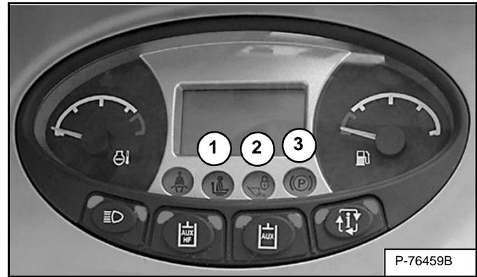
Hay tres luces (ítem 1, 2 y 3) [Figura OI-14] ubicadas en el panel de instrumentos izquierdo que deben estar APAGADAS del todo para operar la máquina.
