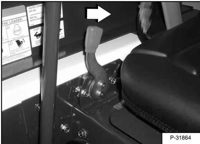
Coloque el control del motor en la posición de velocidad de ralentí (vacío) [Figura OI-81]
