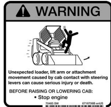
**NOTA:** En las máquinas equipadas con el Sistema de Control Avanzado (ACS), las palancas de dirección pueden hacer contacto con el bastidor de la cabina mientras sube o baja la cabina. El motor DEBE ESTAR detenido antes de subir o bajar la cabina.
