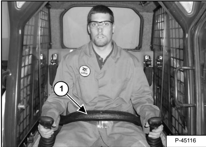
El sistema de restricción tiene una barra del asiento que hace pivote con descansa brazos (ítem 1) [Figura OI-12].
