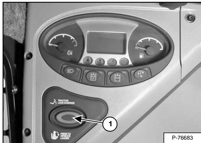
Oprima el botón PRESS TO OPERATE LOADER (ítem 1) [Figura OI-85] para activar el BICS<sup>MR</sup> y para ejecutar las funciones hidráulicas y del cargador.
