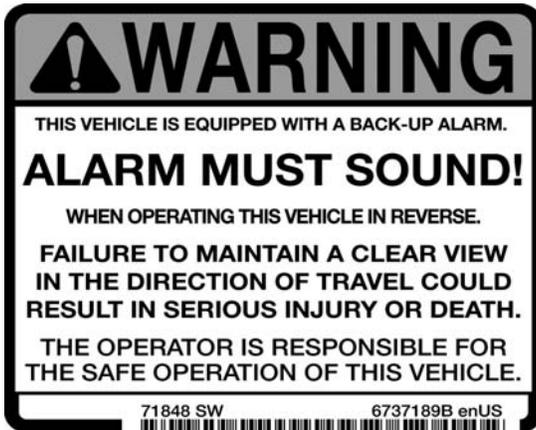
La alarma de alerta de retroceso suena cuando el operador coloca ambas palancas de dirección o joysticks en posición de retroceso [Figura OI-19]. Antes que suene esta alarma, se requiere un leve movimiento de las palancas de dirección con transmisiones hidrostáticas.
