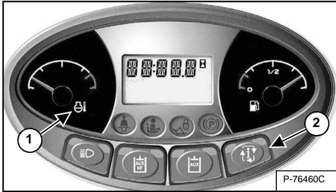
Monitoree frecuentemente los medidores de temperatura y combustible y las lámparas del BICS<sup>MR</sup> (todas deben estar APAGADAS para operar el cargador) [Figura OI-89].
