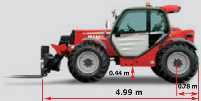
La longitud al tablero inferior a **5 m** y el pequeño voladizo trasero ofrecen toda la compacidad y maniobrabilidad que se puedan necesitar en las obras. El radio de giro de **3.75 m** permite evolucionar fácilmente por los lugares más exigüos.
