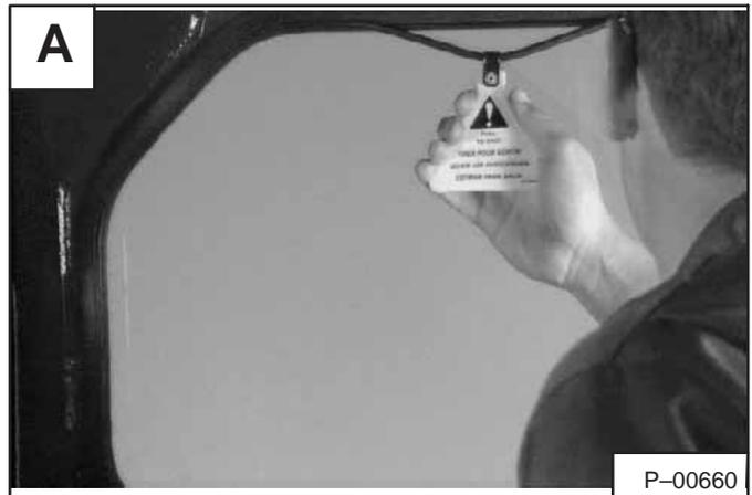
Retire la ventana trasera de la parte trasera de la cabina del operador.
